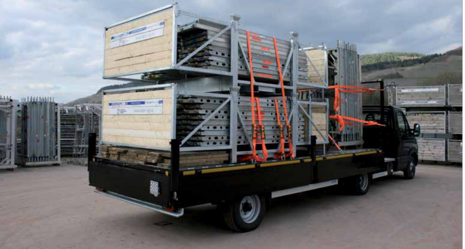
Sicherer Transport mit dem GEROFIXS Transportsystem: die Ladung bildet durch die Transportboxen eine Einheit mit dem Fahrzeug.
